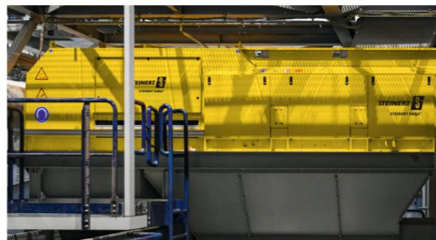
Separação de metais não ferrosos com STEINERT EddyC
