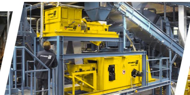
Remoção das peças ferrosas usando STEINERT MOR
