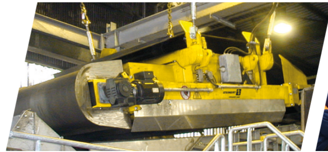
Подвесной магнит (с самоочисткой и воздушным охлаждением) устанавливают в случае, когда в материале постоянно попадают металлические включения.
