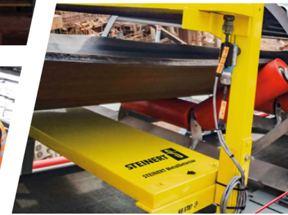
Детекторы металла используются в установках с малым количеством металлических включений.
