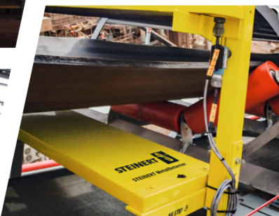
Detectores de metales utilizados en instalaciones con un bajo volumen de material metálico o como instancia de control
