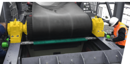
Polea Magnética para la separación de material férrico, como sustituto del tambor de accionamiento de cinta normal
