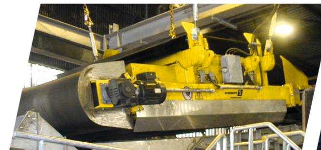
Imán tipo overband (autolimpiante y refrigerado por aire) se utiliza con presencia constante de material ferromagnético en el flujo de material
