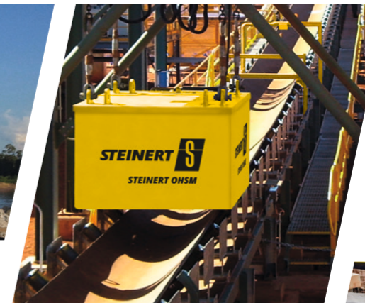
Imán tipo overband (limpieza manual) para cargas elevadas y escasa presencia de elementos ferromagnéticos
