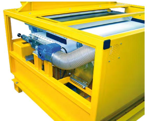
operative fino a 150 cm, spessori nastro a partire da 150 µm per massime intensità di campo, deviatore di precisione per scartare con assoluta accuratezza e fino a tre fasi di lavoro.
