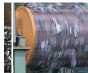
Les tambours magnétiques sont proposés avec pôle radial (S) ou avec pôle axial (Q). Le champ magnétique est constant dans le sens de rotation du tambour à pôle radial (S).
