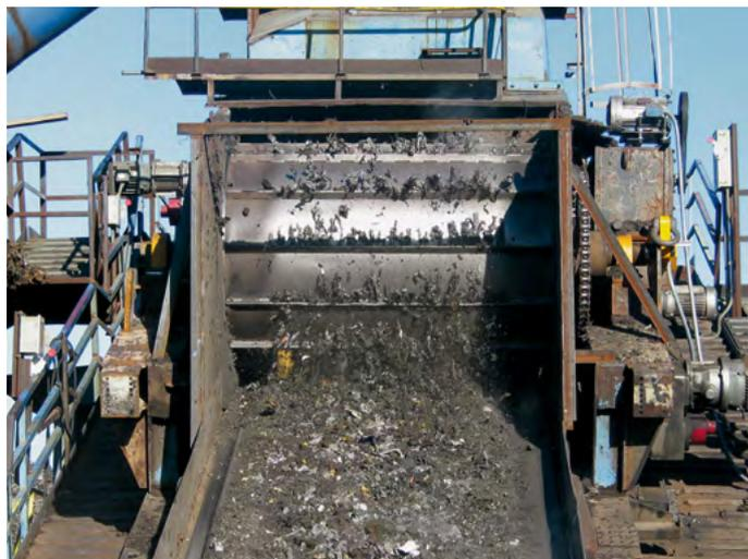
Toutes les pièces magnétiques sont attirées sur le tambour et transportées par la rotation de l'enveloppe à l'endroit où le noyau magnétique s'arrête: les pièces non magnétiques tombent. Les pertes de fer sont minimales. La granulométrie est de taille plus réduite et plus uniforme. Le diamètre de tambour dépend généralement de la taille des particules.
