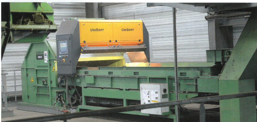
UniSort PR sortiert dunkles Holz aus Kunststoff aus.
