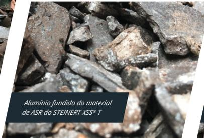
*Alumínio fundido do material de ASR do STEINERT XSS® T*
