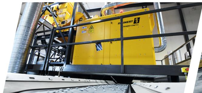
*Purificação de metais pesados não ferrosos de até 5 mm - em cobre,
