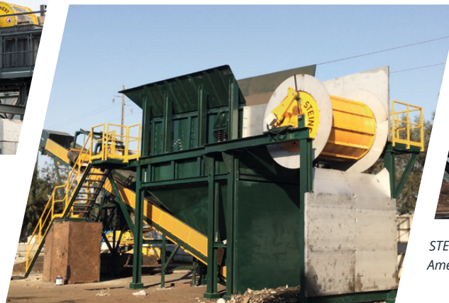
STEINERT MTE Q remove resíduos e materiais não ferrosos em uma usina de reciclagem na Espanha
