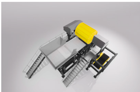
Layout 1: Configuração com alimentador de vibração e STEINERT MTE e STEINERT UME no fluxo do material de descarte do STEINERT MTE.
